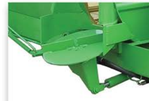
Inclinazione idraulica del piatto idraulico Hydraulic inclination of lateral disc by cylinder
