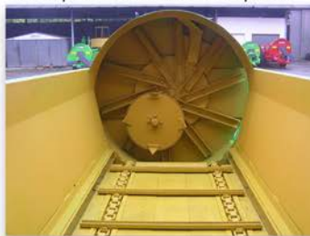
Turbina con fresa sminuzzatrice e coltello raschiatore Turbine spreader with cutter rotor and scraper knife
