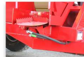
Piatto localizzatore a piede filare idraulico Lateral disc to localize manure on the row - hydraulic
